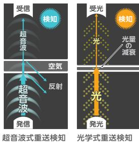
超音波式重送検知 光学式重送検知
