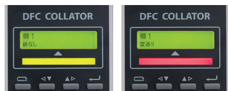
紙なし、紙受台の満載など、通常運転で停止した場合は緑色に点灯。重送、紙づまり、空送りなど、エラーで停止した場合は赤色に点灯。
